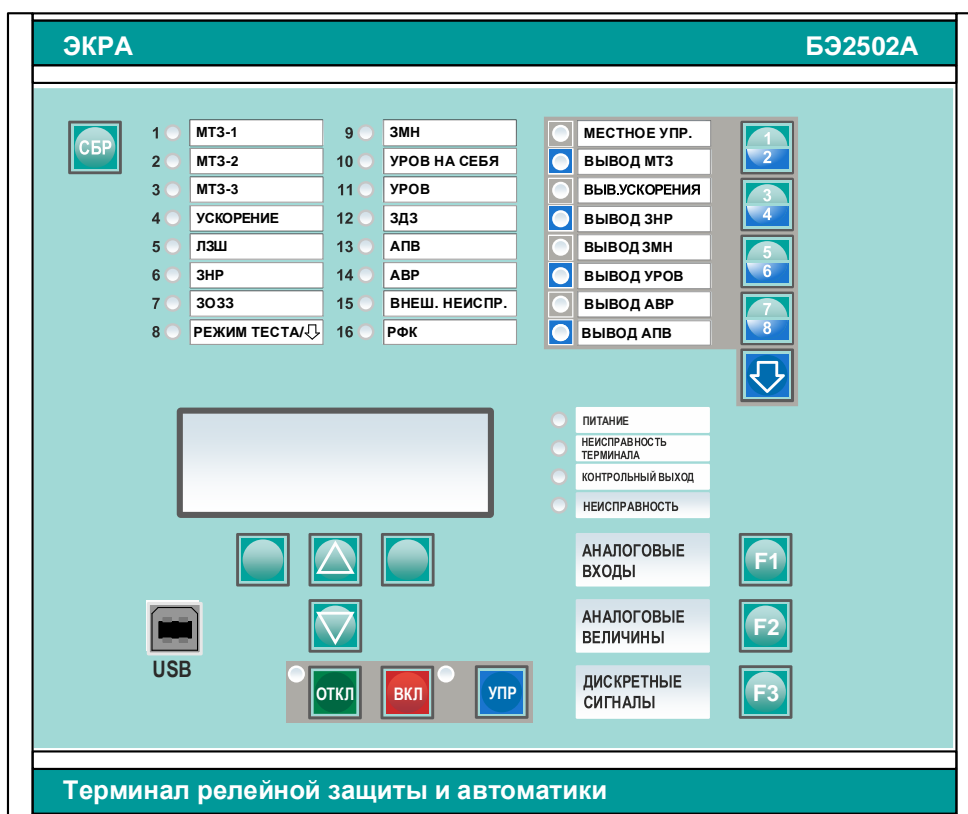
Рисунок 6.3 - Расположение элементов на лицевой панели терминала БЭ2502А0303
